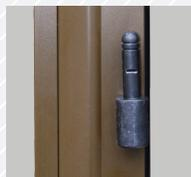
Gonds composite avec tige inox à visser en façade à l'intérieur du précadre: aucune vis apparente et meilleur clair de baie!
