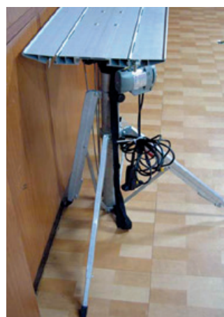
4 ème pied stabilisateur à réglage individuel sur sa propre bague
