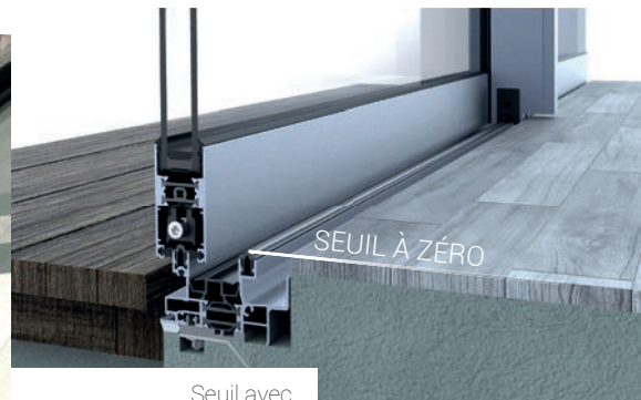
Seuil avec encastrement total intérieur et extérieur SEUIL À ZÉRO
