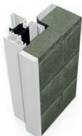
POSE EN FEUILLURE SANS RECOUVREMENT
