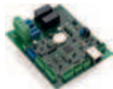
Door Controller LAN
