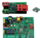
Retrofit kit simplifié E045 En remplacement d'une 455D (installée sans gatecoder)
