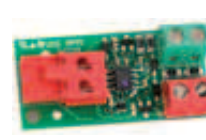
Interface BUS XIB (pour la carte E045 ou E024S avec photocellule pas BUS)
